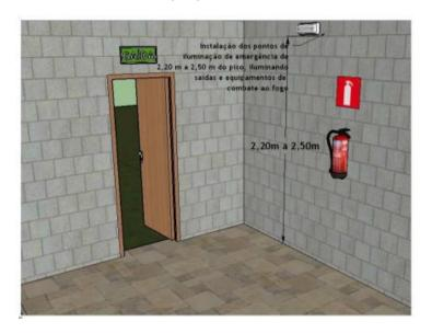
Pode-se ligar as luminárias em uma central de iluminação de emergência, com baterias adicionais – caso desejado, ou, caso seja dispensada a central, as luminárias de emergência devem estar conectadas à tomadas pertencentes à um mesmo circuito ou à circuitos específicos para esta finalidade.
