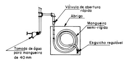
A tubulação e conexões devem ser em aço galvanizado, de bitola indicada em planta, obedecendo os preceitos da NBR 5580. Quando enterrados, deverão ser envelopados com areia e concreto magro.
