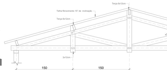
DETALHE MADEIRAMENTO TELHADO
