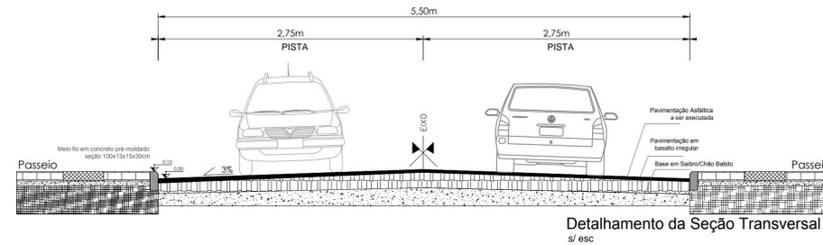
Detalhamento da Seção Transversal s/ esc
