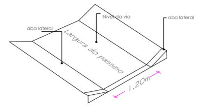
RAMPAS DE ACESSIBILIDADE E REBAIXOS DE MEIO FIO SEM ESCALA
